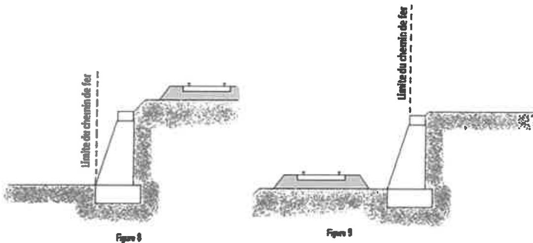
Lorsque le chemin de fer est établi en remblai et que le talus a été rechargé ou modifié par suite d'apport de terre ou d'épuration de ballast, la limite du chemin de fer pourra être déterminée à partir du pied du talus primitif, à moins toutefois que cet élargissement de plate-forme ne soit destiné à l'établissement prochain de nouvelles voies.
